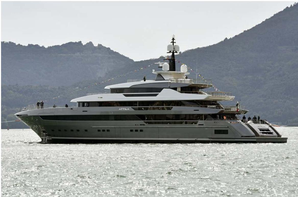
Con 1.600 tonnellate lorde, 64 metri di lunghezza, cinque ponti e una larghezza massima interna di 12,5 metri, **64 Steel Attila** è l'ammiraglia della linea superyacht "Steel" di Sanlorenzo con scafo in acciaio.
