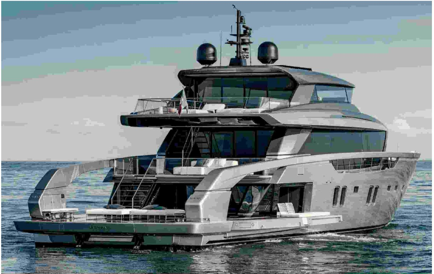
Offene Heckpartie: Das Schanzkleid öffnet sich auf acht Metern Länge und ermöglicht den seitlichen Zugang zum Beachclub.
